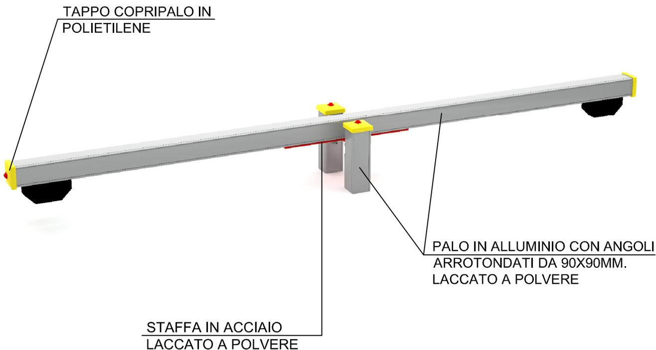
TUTTI GLI ELEMENTI DI FISSAGGIO, VITI, DADI, RONDELLE ECC. SONO IN ACCIAIO ZINCATO E PROTETTI DA GHIERE E TAPPI IN POLIETILENE.
